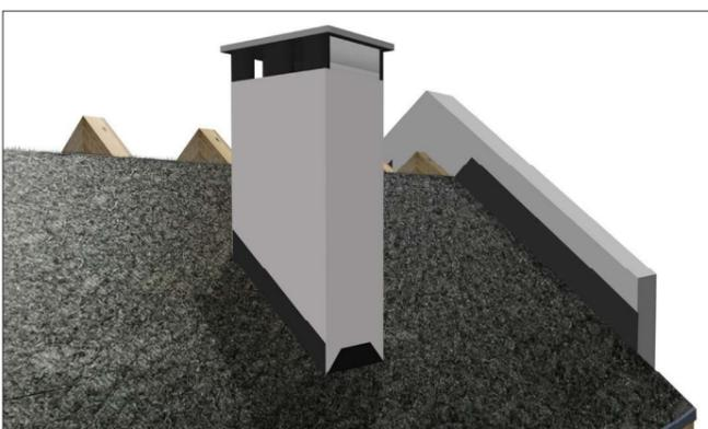
Bei Dachdurchdringungen (z. B. Schornsteine, Gauben und Brandmauern) muss die Bahn nach oben geführt (10-15 cm hoch) und an der Wand/dem Schornstein abgedichtet werden (mit mdm ViBest Butyl Band). Falls erforderlich, kann die Drainageschicht von dem oberen Teil der Bahn entfernt werden.
