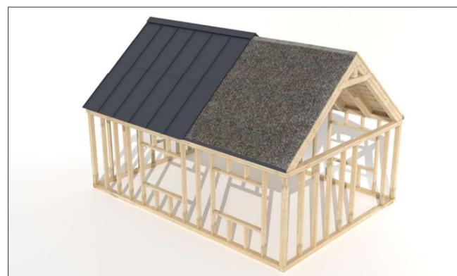
Sobald die Dachbahn verlegt und befestigt ist, kann mit der Montage des Flachblechs begonnen werden. Die Bedeckung mit Blech sollte gemäß den Anweisungen des Herstellers des verwendeten Dachmaterials erfolgen.
