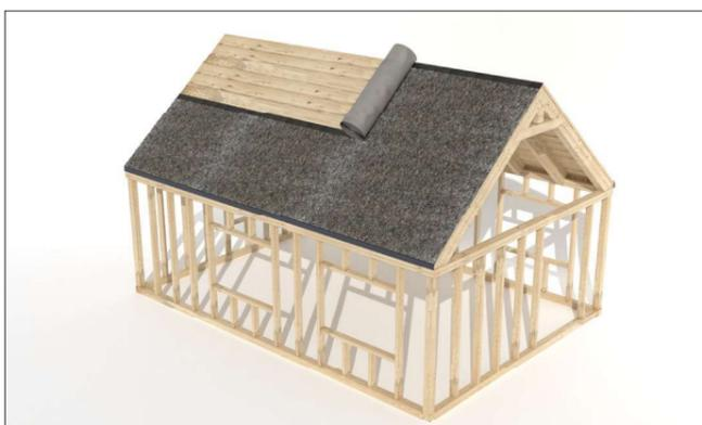
Es ist unbedingt zu vermeiden, die Dachbahn direkt auf frisch imprägnierte Elemente zu verlegen. Das Bespritzen der Dachbahn mit Öl (z.B. von einer Kettensäge) und der Kontakt mit ungetrocknetem Holzschutzmittel (frisch imprägnierte Bretter) muss unbedingt vermieden werden, da dies zu einer Beschädigung der Bahn führen kann. Die Dachbahn sollte unter trockenen Bedingungen verlegt werden, um zu vermeiden, dass Feuchtigkeit darunter eingeschlossen wird.
