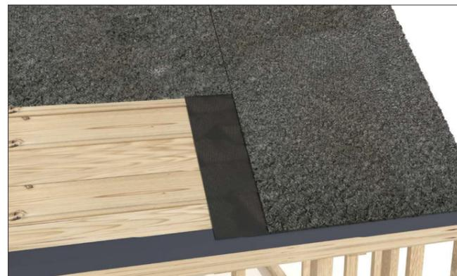
Es wird empfohlen, vertikale Nähte der Dachbahn zu vermeiden. Vertikale Verbindungen zwischen zwei Bahnen (z. B. nach Verbrauch einer Rolle) sollten sehr sorgfältig mit einer Überlappung von mind. 20 cm ausgeführt werden. Entfernen Sie mind. 20 cm der Drainageschicht (über die gesamte Breite) von einem der verbindenden Bahnenstreifen, damit die Abschnitte miteinander verklebt werden können.
