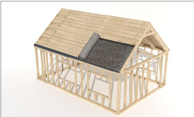
Verlegen Sie die Dachbahn eng anliegend (Drainageschicht nach oben) auf der vorbereiteten Konstruktion. Die mdm®Ventia Metal Dachbahn sollte direkt auf der massiven Dachschalung (z.B. aus Brettern oder Platten) verlegt werden. Der vorbereitete Untergrund sollte sauber, trocken und frei von Verunreinigungen sein (bei renovierten Dächern sollten die Reste aller zuvor verlegten und benutzten Schichten entfernt werden, bevor die Dachbahn verlegt wird).
