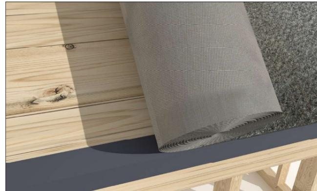
Die Dachkehle (und andere Vertiefungen in der Dachneigung, in denen sich Wasser ansammeln kann) sollte mit mindestens einer doppelten Lage der Dachbahn geschützt werden. Der untere Streifen der Dachbahn sollte die angrenzende Dachfläche überlappen (Überlappung mind. 20-30 cm). Der untere Bahnenstreifen an der Stelle der Überlappung sollte von der Drainageschicht befreit werden. Der obere Dachbahnstreifen sollte entlang der Achsenlinie der Dachkehle geschnitten werden.
