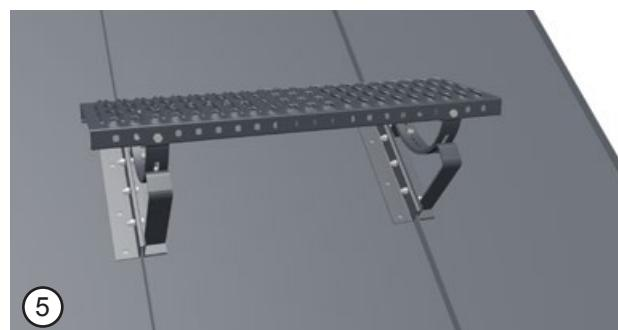
Po zamocowaniu drugiego wspornika z mocownikiem należy przykręcić ławę kominiarską. Następnie należy sprawdzić poprawność wykonanego montażu, w szczególności należy sprawdzić stabilność wszystkich połączeń mechanicznych.
